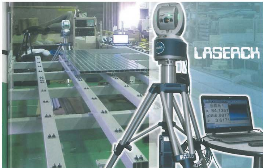
導入した「レーザートラッカー」
